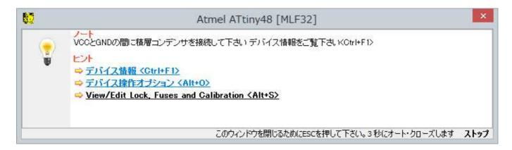
デバイスの動作がプログラミンクやイレースにおいて不安定な場合 22nF-100nF 積層コンデンサ (EIA X7R 又は Z5U スペックに合った)をデバイスの GND と VCC ピンの間に入れて下さい DIL32/MLF32-1 ZIF-CS (70-0190)のピンは: VCCpin = DIL7, GNDpin = DIL5 となります。
